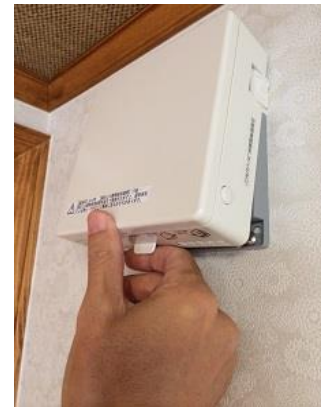
③次にカバーを外します。 下部の突起を手前に引くと外れます。
